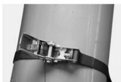
将布带穿过拉紧器旋轴中间的横槽, 并用手拉紧。
