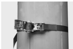
连续拉动拉紧器扳手即可拉紧布带
