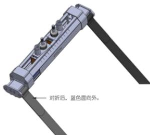
将魔术带穿过管道，黑面朝上穿过支架探头的魔术带紧固支架，对折后用力拉紧，调正支架探头的方向，然后再粘贴牢固。
